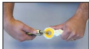
**Si la inspección revela un defecto en el estado, ponga fuera de servicio las unidades. Todo equipo sometido a una caída debe ser puesto fuera de servicio. Los productos retirados del servicio deben desecharse de tal manera que se prevenga su posterior uso por accidente.**
